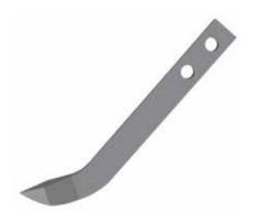
Der Zahn hat eine stachelförmige, abgeflachte Form und ist am Ende spitz und in einem Winkel gebogen. Dies ermöglicht es, in einem Winkel von 90° in den Boden einzudringen. Das Durchdrehen beim Anheben vom Boden erzeugt den Effekt einer Mikroexplosion. Somit wird die Bodenkruste vollständig zerstört und das Unkraut im Fadenstadium entfernt.
